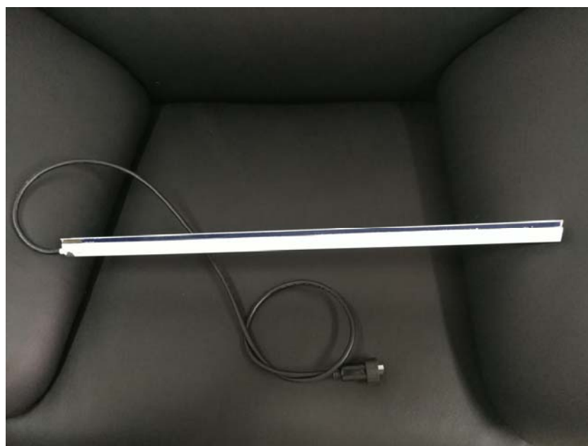
与温度传感器配套使用，具有 0.6 毫米分辨率的水面位置测量装置
