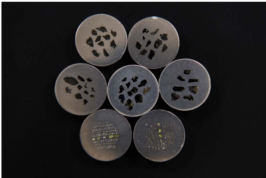
图 3 合金材料样品靶实物图
