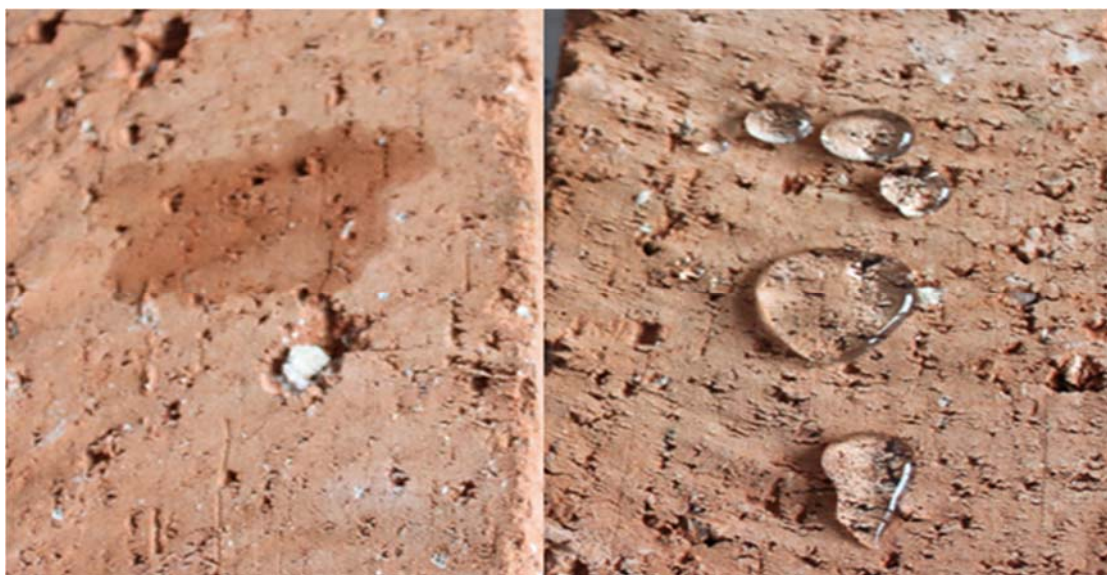
喷洒聚氨酯防水涂料前（左）后（右）表面亲水性的变化
