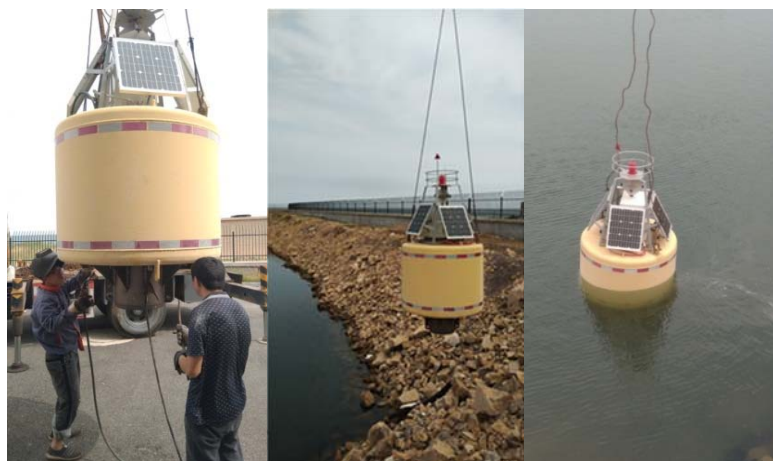
图 1 配重搭与试验场测试
