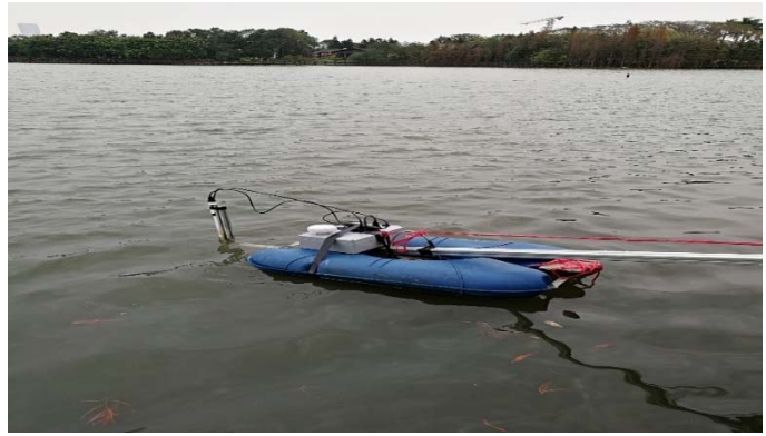
第二代皮温仪样机 BEST-1600 开展现场测量试验
