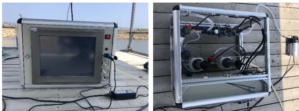
图 1 船载海洋生态环境多参数在线监测系统
