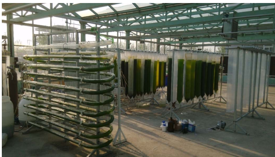
产神经酸微藻规模化培养的中试系统实景图
